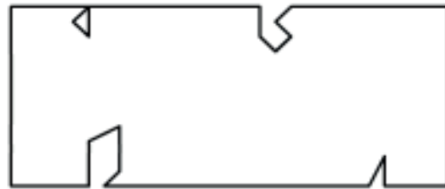
Esquema de la corrosión por picadura
